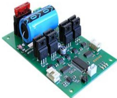
Figure 2 - Contrôleur de moteur MD49
